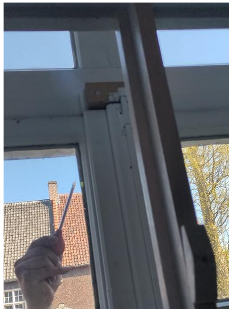
Figuur 15. Rook die door een slechte aansluiting van de opengaande raamvleugels van buiten naar binnen stroomt.
